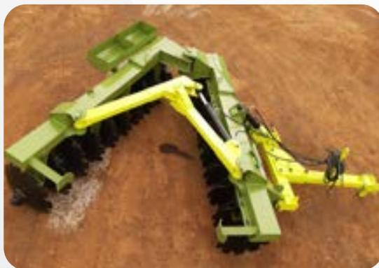
A **Grade Aradora Pesada de Arrasto com Abertura Mecânica ou Hidráulica (GAPM\_H)** foi projetada para ser utilizada no preparo de diferentes tipos de solo, previamente cultivados ou abertura de novas terras destinadas ao plantio, fazendo este trabalho com qualidade e perfeição requeridas pelos agricultores de diversas culturas. Este modelo oferece ampla regulagem para ajuste de ângulo de corte da grade, com cilindro hidráulico e mecânico.
