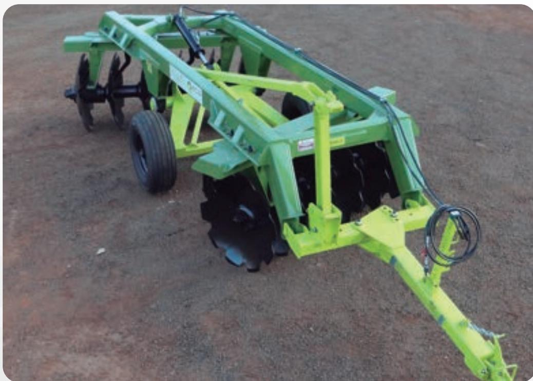
A **Grade Aradora Pesada\_Compacta GAP\_C** foi projetada para ser utilizada na reforma de diferentes tipos de solo, previamente cultivados ou abertura de novas terras destinadas ao plantio, fazendo este trabalho com qualidade e perfeição requeridas pelos agricultores de diversas culturas. O equipamento possui barra estabilizadora e conjunto de rodado com 2 pneus 11L15 acionado via comando hidráulico direto da cabine do trator (controle remoto).
