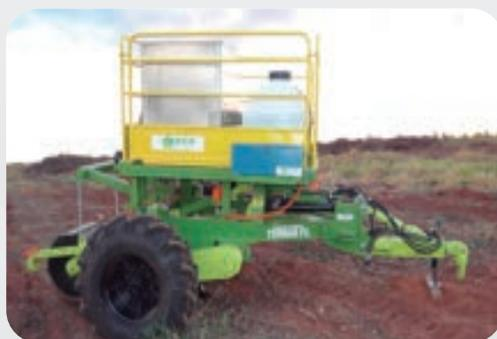
O **Aplicador de Insumos Florestal EcoAgrícola** tem a função de trabalhar na linha onde o subsolador já realizou o trabalho de descompactação e preparo do solo, realizando a adubação química através de uma haste a uma profundidade de 300 a 350mm. O equipamento também faz a marcação de onde será feito o plantio das mudas e a aplicação do herbicida pré-emergente.
