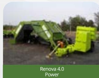
Túnel 4,0 metros, possibilidade de trabalhar com leiras em dimensões aproximadas de 4,0m L x 1,50m A. Tração por trator 4x4 com potência sugerida acima de 90 a 120cv (variável para + ou para - de acordo com as condições do pátio), equipado com super-reductor e com 01 comando hidráulico (cilindro). Opcional kit aletas MAXXCORTE: especialmente desenhadas para aumentar o desempenho e melhorar a performance do equipamento. Opcional: TDP 540RPM ou 1.000RPM.
