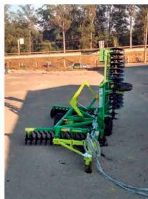
O mecanismo de levante do quadro lateral é realizado através de um braço acionado através de cilindro hidráulico independente, o que confere segurança e simplicidade operacional, além de eliminar a necessidade de manutenção do mecanismo. O conjunto de rodado conta com pneus 11L15 e 400x60 no quadro lateral direito e 1 pneu 11L15 no quadro lateral esquerdo.
