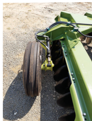
RODADO COM ACIONAMENTO HIDRÁULICO
