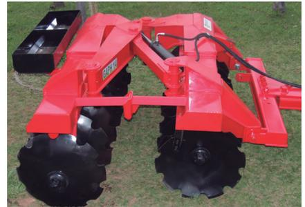
A **Grade Aradora Pesada de Arrasto com Abertura Mecânica ou Hidráulica (GAPM\_H)** foi projetada para ser utilizada no preparo de diferentes tipos de solo, previamente cultivados ou abertura de novas terras destinadas ao plantio, fazendo este trabalho com qualidade e perfeição requeridas pelos agricultores de diversas culturas. Este modelo oferece ampla regulagem para ajuste de ângulo de corte da grade, com cilindro hidráulico e mecânico.
