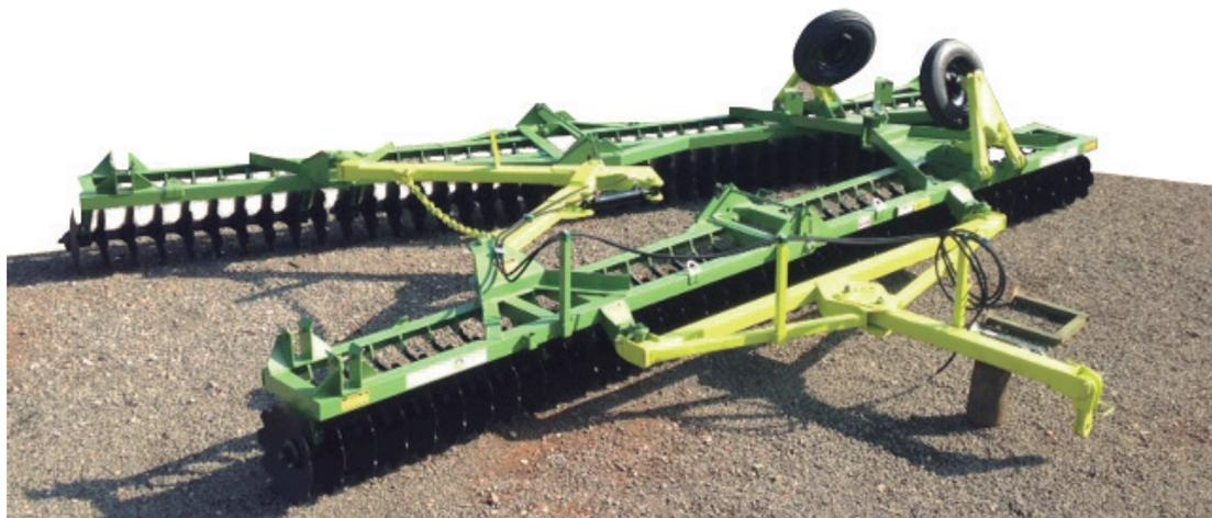
A **Grade Niveladora Flutuante** é fabricada nos tamanhos 36 a 80 discos, sem tandem, com opcional de discos recortados na seção dianteira e lisos na seção traseira, que conferem melhor acabamento do solo. A GNFE garante excelente desempenho no destorroamento, nivelamento e bom acabamento do ciclo de preparo do solo, permitindo assim, que as demais operações, como plantio e posterior colheita mecanizada, possam ocorrer com o máximo de eficiência.
