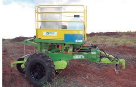
O **Aplicador de Insumos Florestal EcoAgrícola** tem a função de trabalhar na linha onde o subsolador já realizou o trabalho de descompactação e preparo do solo, realizando a adubação química através de uma haste a uma profundidade de 300 a 350mm. O equipamento tem também faz a marcação de onde será feito o plantio das mudas e a aplicação do herbicida pré-emergente.
