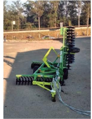
O mecanismo de levante do quadro lateral é realizado através de um braço acionado através de cilindro hidráulico independente, o que confere segurança e simplicidade operacional, além de eliminar a necessidade de manutenção do mecanismo. O conjunto de rodado conta com pneus 11L15 e 400x60 no quadro lateral direito e 1 pneu 11L15 no quadro lateral esquerdo.
