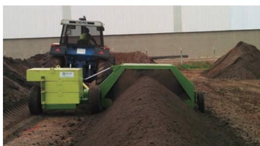
Túnel de 2,5 metros - possibilidade de trabalhar com leiras em dimensões aproximadas de 2,5m x 1,30m com 01 rotor "aletado" em "aspiral", acionado por cardan / redutor. Tracionado por trator 4x4 com potência sugerida de 65 a 85cv (variável para + ou para - de acordo com as condições do pátio), equipado com super-redutor e com 01 comando hidráulico (cilindro).
