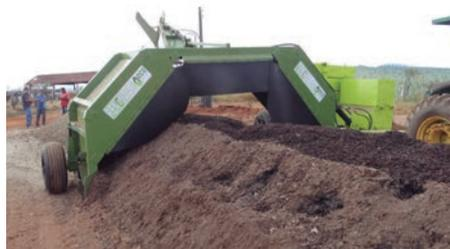
Túnel 4,0 metros - possibilidade de trabalhar com leiras em dimensões aproximadas de 4,0m L x 1,50m A. Tractionado por trator 4x4 com potência sugerida acima de 90 a 120cv (variável para + ou para - de acordo com as condições do pátio), equipado com super-redutor e com 01 comando hidráulico (cilindro). Opcional kit aletas MAXXCORTE: especialmente desenhadas para aumentar o desempenho e melhorar a performance do equipamento. Opcional: TDP 540RPM ou 1.000RPM.
