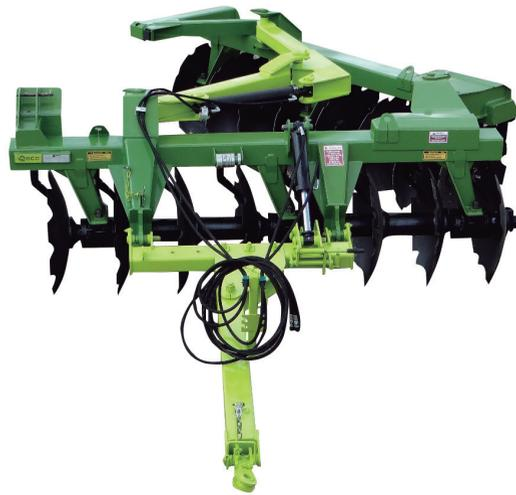
A **Grade Super Pesada com Abertura Mecânica ou Hidráulica (GSP\_H)** foi projetada para ser utilizada no primeiro estágio da preparação do solo, abertura de novas áreas e/ou erradicação de cana-de-açúcar. Devido às condições severas e pesadas de trabalho as quais são destinadas, este modelo oferece ampla regulagem para ajuste de ângulo de corte da grade com cilindro hidráulico ou mecânico.
