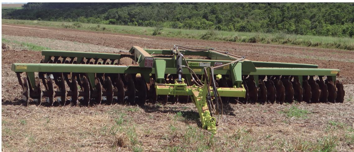
A **Grade Niveladora Modelo GNE**, foi desenvolvida para garantir o destorroamento, nivelamento e bom acabamento do ciclo de preparo do solo, permitindo assim que as demais operações como plantio e posterior colheita mecanizada, possam ocorrer com o máximo de eficiência. O conjunto do rodado possui 2 pneus 11L15 ou 400/60 (opcional), acionados via comando hidráulico, direto da cabine do trator (controle remoto), para realizar o transporte com a maior praticidade possível.
